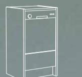
Geschirrsp. - Verbau Tiefe 60 / Stollen: 3 od. 5 cm Verbau UH 66/51 GS1=116,3 hoch
